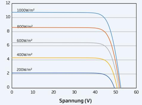
**P-V KURVEN DES PV-MODULS (445 W)**
